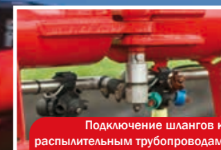
Подключение шлангов к распылительным трубопроводам
